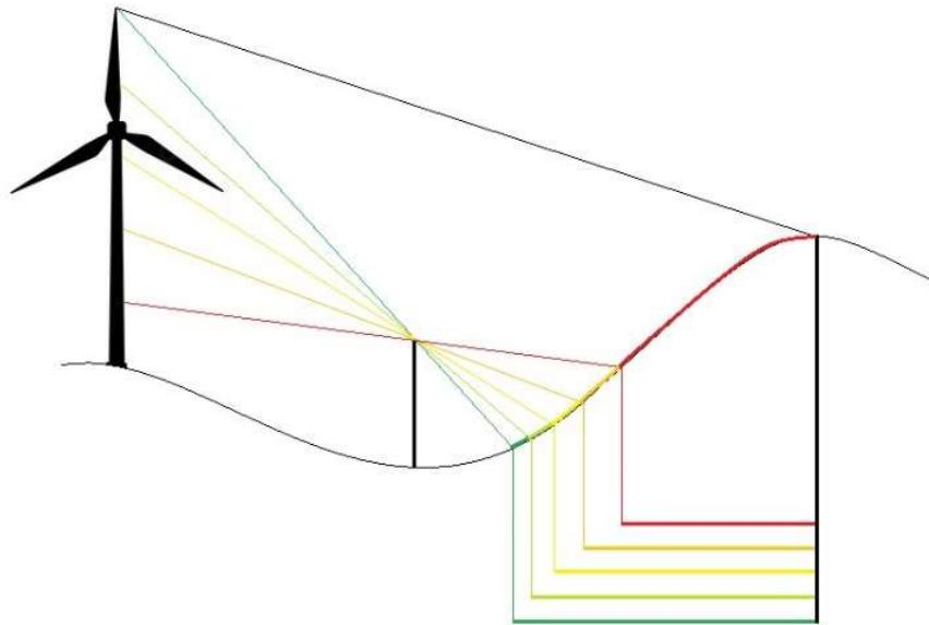
Der sichtbare Layer bestimmt die Sichtbarkeitsklasse. Die Layer werden entsprechend zusammengeführt und dargestellt.
